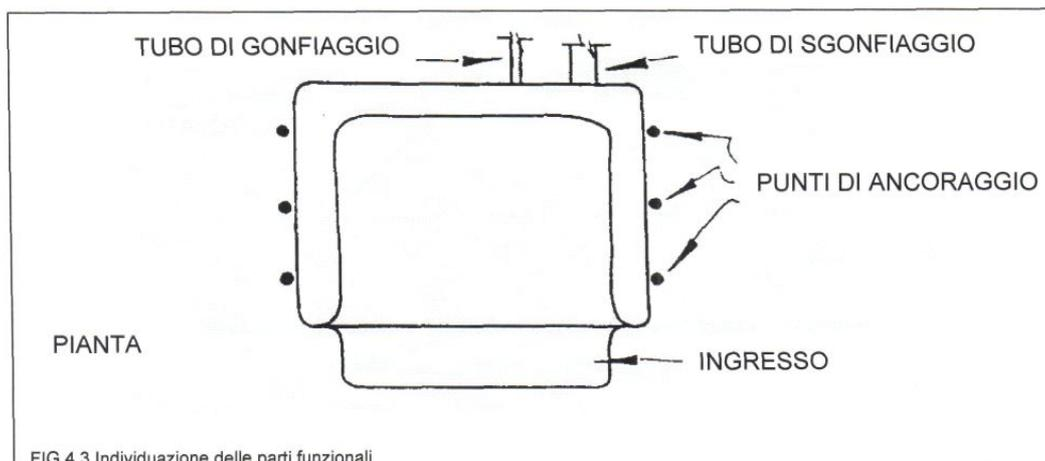
4. Fissare gli ancoraggi come definito nel paragrafo 4.6 nelle posizioni individuate mediante l'operazione di primo gonfiaggio descritta nel paragrafo 4.5.
